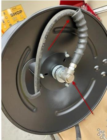
6. INSTALLER LA CIRCLIP POUR LE JOINT PIVOTANT, L'ATTACHE DE RETENUE POUR LE BOYAU, ET LA POIGNÉE.
