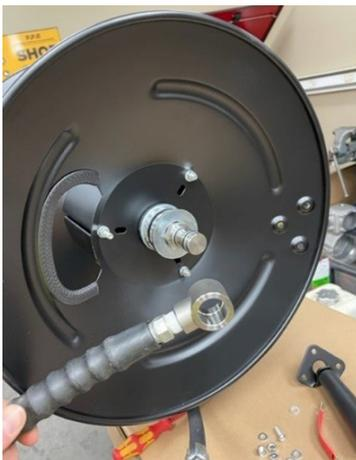
4. ENFILEZ LE TUYAU AVEC LE JOINT PIVOTANT INSTALLÉ DANS L'OUVERTURE DE L'INTÉRIEUR VERS L'EXTÉRIEUR.
