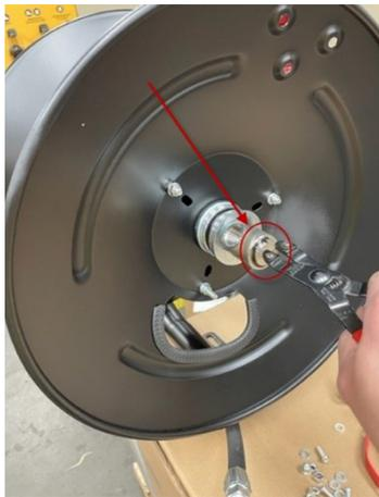
2. RETIRER LE CORPS DU JOINT PIVOTANT DE LA TIGE
